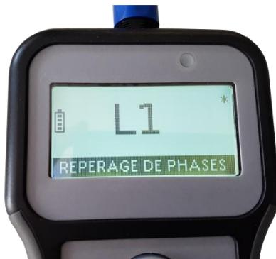
Il faut noter toutefois que si le neutre n'est pas connu visuellement il ne pourra être repéré de manière explicite car aucun signal spécifique n'est sensé circuler dessus.
