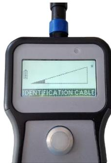
On positionne ensuite le capteur à plusieurs endroits le long du câble afin d'obtenir un niveau de signal maximum.
